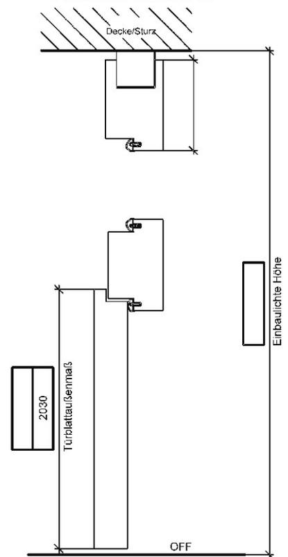
OFF = Oberkante fertiger Fußboden
