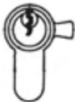
Doppio cilindro del sistema \*\*\*\*\*, con la cam libera di ruotare a 360° e la predisposizione per apertura con chiave di emergenza (l'apertura con una chiave autorizzata è possibile anche se c'è una chiave inserita nell'altro lato del cilindro). Se questo cilindro è utilizzato con serrature antipanico, in accordo alla normativa EN179 oppure EN 1125, prega si controllare la dichiarazione di conformità del produttore della serratura.
