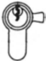
DOPPELZYLINDER System \*\*\*\*\*, mit Freilauf 360° und Rettungswegsperrung (Sperren mit berechtigtem Schlüssel ist auch möglich, wenn auf der gegenüberliegenden Zylinderseite ein Schlüssel angesteckt ist). Sollte dieser Zylinder in Panikverschlüsse gemäß der EN179 bzw. EN1125 eingesetzt werden, beachten Sie bitte die Konformitätserklärung des Türschlossherstellers!
