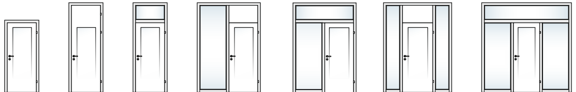
1-flügelig, mit/ohne Verglasung, mit/ohne Oberblende, mit/ohne Oberlicht- und oder Seitenteilverglasung
