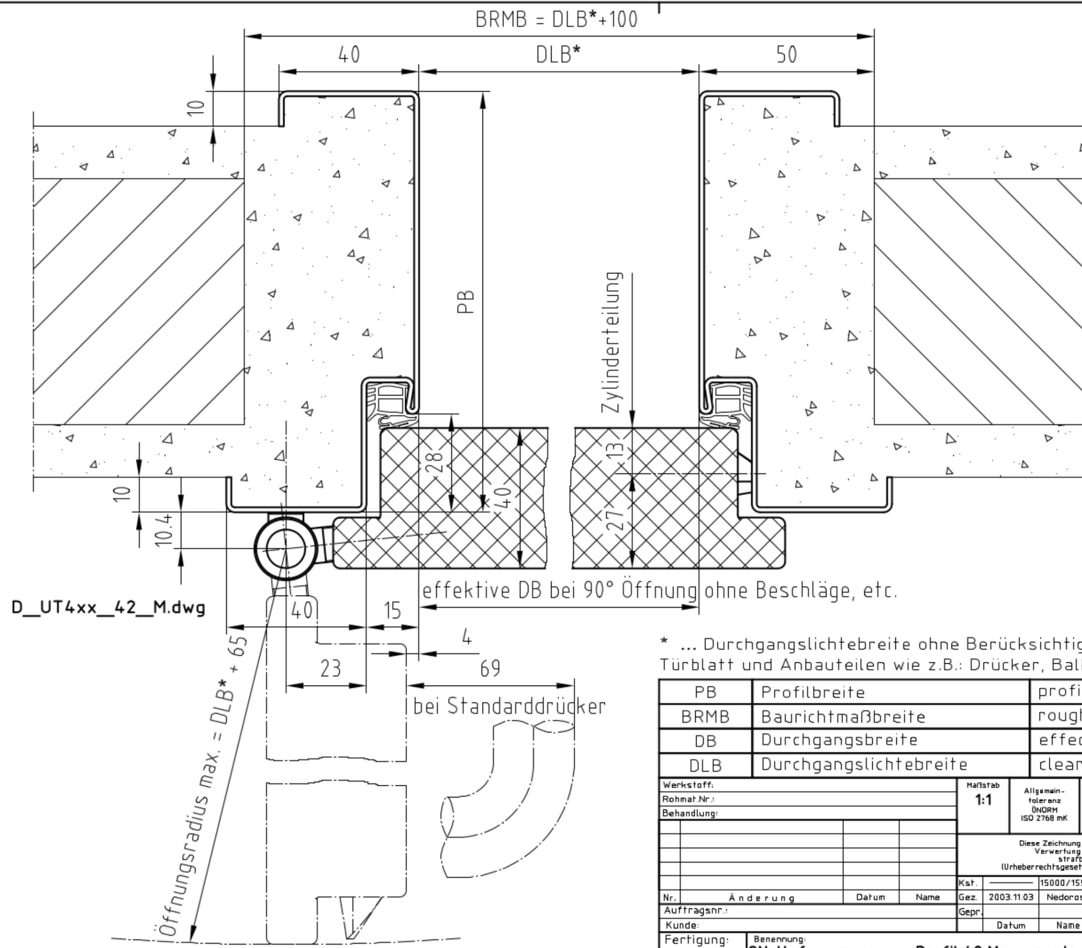
\* ... Durchgangslichtbreite ohne Berücksichtigung von geöffnetem Türblatt und Anbauteilen wie z.B.: Drücker, Balken, Türschließer, usw.
